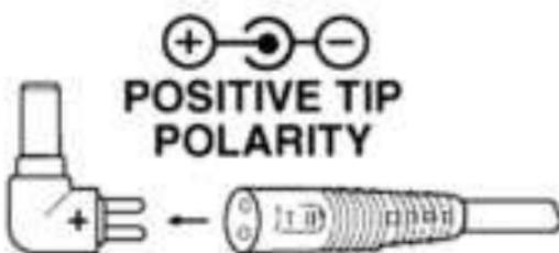
4. Zapojte napájecí konektor adaptéru do napájeného zařízení.
