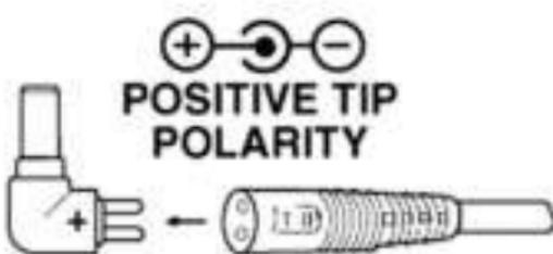
4. Illessze be a csatlakozódugaszt az elektronikus készülékbe.
