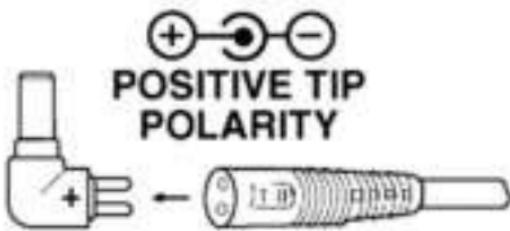
4. Insérez la prise de sortie du connecteur dans votre équipement électronique.
