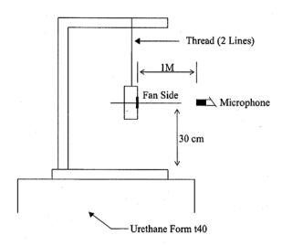
1 METER FROM MICROPHONE TO FAN INTAKE
