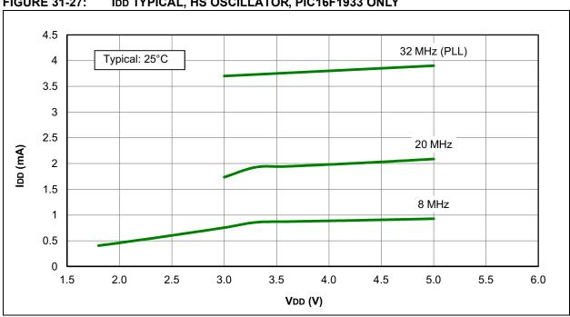
FIGURE 31-27: IDD TYPICAL, HS OSCILLATOR, PIC16F1933 ONLY
