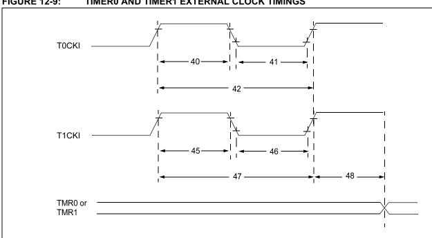
**FIGURE 12-9:** TIMERO AND TIMER1 EXTERNAL CLOCK TIMINGS
