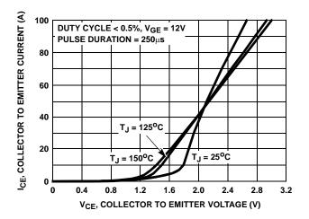
FIGURE 5. COLLECTOR TO EMITTER ON-STATE VOLTAGE
