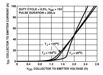
FIGURE 6. COLLECTOR TO EMITTER ON-STATE VOLTAGE
