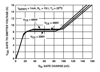
FIGURE 14. GATE CHARGE WAVEFORMS
